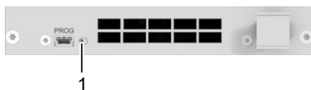
Fig. 68 Interface side fan cartridge module - Status LEDs
