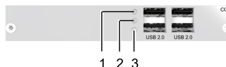
Fig. 42 Interface side add-on module USB 2.0 – Status LEDs L-/R474-BXE2
