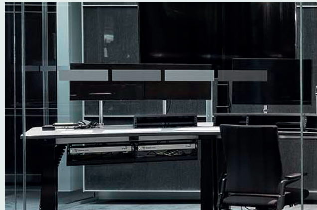
Ergonomische Arbeitsplätze im SRF-Sendezentrum: statt sperriger und geräuschintensiver Server befinden sich kompakte Extender unter den Schreibtischen
